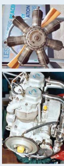
4 cylindres à plat diesel - 7 cylindres rotatifs en étoile
