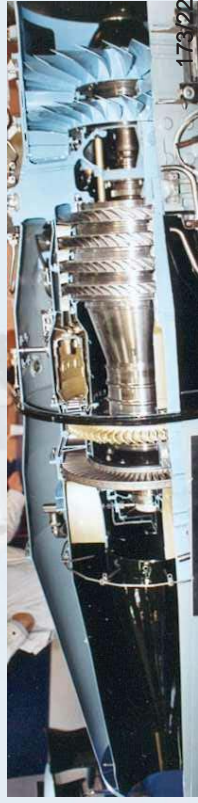
Réacteurs double corps – double flux : civil de chez PW et militaire (LARZAC – \alpha jet).
